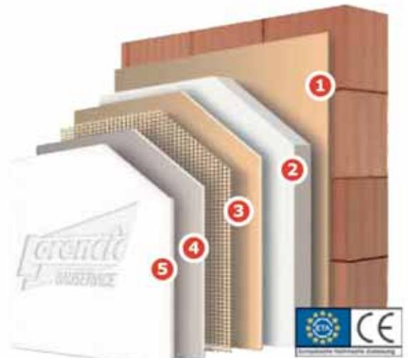
Das klassische, kostengünstige Wärmedämmverbundsystem mit LORENCIC Klebspachtel (Armierungsschichtdicke 3 mm), herkömmlichen EPS-F Fassadendämmplatten 040 oder hochwärmedämmenden grauen EPS-F Fassadendämmplatten 031.
