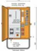
**Baustromverteiler NÖ M-AVEV 35/11-3/V1/A**
