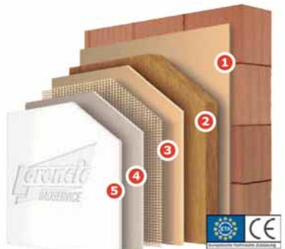
Dämmen mit Mineralwolle verbindet Sicherheit mit optimalem Wärme- und Umweltschutz. Mineralwolle ist hoch wärmedämmend, sehr diffusionsoffen, nicht brennbar und daher besonders für Gebäude mit Brandschutzanforderungen geeignet.
