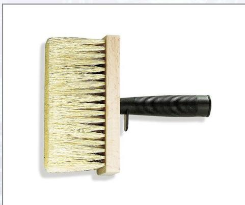
Ideal für die Beschichtung von größeren Flächen zB Decken und Wänden. Mischung aus Fibre- und Kunstborste, Stiel aus Kunststoff. Haupteinsatzzweck: Teer und Bitumen. Breite 170 mm, Dicke 70 mm, Borstenlänge 70 mm.
