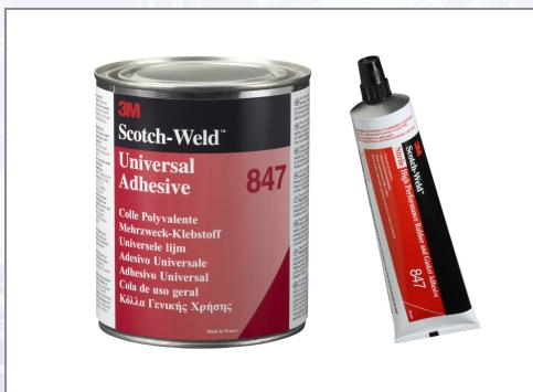
Mehrzweck-Klebstoff auf Nitrilkautschukbasis mit hoher Festigkeit und guten Alterungseigenschaften. Zum Kleben von PVC und ähnlichen Kunststoffen, Nitrilkautschuk, Gummi, Stahl, Alu, Holz, Leder und Dichtmaterialien. Beständig gegen Öle, Treibstoffe, Weichmacher. Erhöhte Wärmefestigkeit. Hitze- und lösemittel- reaktivierbar.
