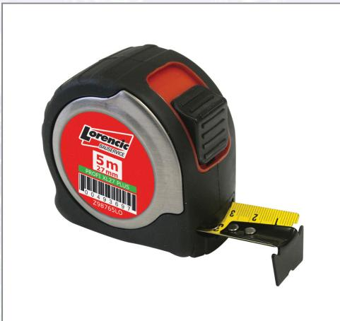
Professioneller Rollmeter aus rostfreiem Stahl mit rutschfester Gummibeschichtung. Bandbreite 27 mm, texturierte Oberfläche des Bandes, Teilung auf beiden Seiten des Bandes (Vorderseite waagerechte Skalierung, Rückseite senkrechte Skalierung), 10 Mal höherer Abriebsschutz des Bandes. Sonder-Steifigkeit des Bandes gewährleistet Knickfestigkeit bis 2,6 m horizontal und 4 m vertikal. EG-Genauigkeitsklasse II.
