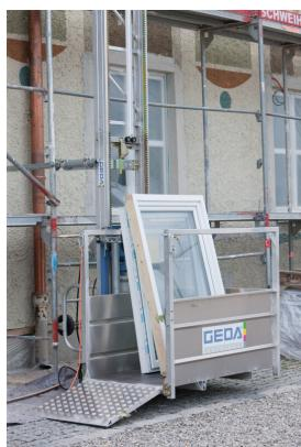
Der universelle Aufzug zum Materialtransport, einfache und schnelle Befestigung, beidseitig 90 ° schwenkbar. Ideal für Gerüstbauer und Bauhandwerker. Tragfähigkeit 200 kg, Hubgeschwindigkeit 25 m/min, Bühnengröße 0,8x1,4x1,1 m, Förderhöhe bis max. 35 m. Grundeinheit bestehend aus: Fußteil 2 m, Schlitten mit Antrieb 1,7 kW/230 V/50 Hz und geschwindigkeitsabhängiger Fangvorrichtung, Steuerung 5 m und steckbar, Federkabeltrommel mit Schleppkabel, Fahrgestell.
