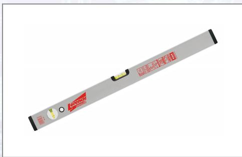
Alu-Rohrprofil silber eloxiert mit 1 Waagrecht- und 1 Senkrechtlibelle. Dimensionen 48x22 mm, 560 g/lfm. In den Längen 150 und 200 cm: 610 g/lfm. Libellen elektronisch kontrolliert, Waagrechtlibelle mit Vergrößerungslinse und Leuchtbeflag, unzerbrechliche Acrylglas-Blocklibellen und stoßdämpfende Endkappen. Maximale Messtoleranz in Standardposition 0,5 mm/m (0,029 °).
