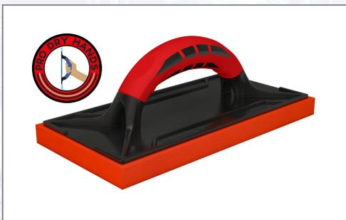
Das Profi-Reibebrett COMMODORE mit Mittelgriff und patentierter definiert geführter Wasserableitung "PRO DRY HANDS". Es besitzt zwei tunnelförmige Griffdurchlässe, die beim Bearbeiten von Putzen den Weg des Schmutzwassers an der Reibebrettoberseite definieren und es ableiten ohne dabei die Arbeitsbekleidung zu beschmutzen. Durch die erhöht zulaufenden Wasserleitstege wird zusätzlich die Stabilität der Grundplatte erhöht. Mit ausbalanciertem ergonomischem
