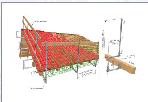
Zur seitlichen Absicherung der Dachfläche, zertifiziert nach EN 13374 Klasse A. Verschiebbare Ausführung damit das Geländer immer direkt an der Dachkante steht. Sichere Klemmung auf dem Sparren am Dachende. Stabile feuerverzinkte Ausführung für Ihre Sicherheit. Auch zum Einlegen von Holzbrettern geeignet.
