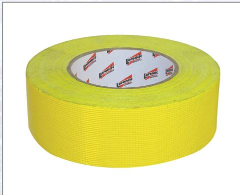
Kaschiertes Polyäthylen-Gewebe-Klebeband, beschichtet mit aggressivem, druckempfindlichem Kleber. Materialstärke: 0,2 mm, Dehnfähigkeit: 20 %, Klebekraft Stahl: 3,7 N/cm. Anwendungstemperatur: +10 ° bis +45 °C, Temperaturbeständigkeit: -50 ° bis +65 °C. Leicht abreiß- und abrollbar, extrem formanpassungsfähig, wasserfest, hoher Abriebwiderstand. Besonders geeignet für die Verklebung auf Untergründen mit Restfeuchtigkeit.
