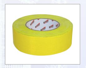
Kaschiertes Polyäthylen-Gewebe-Klebeband, beschichtet mit aggressivem, druckempfindlichem Kleber. Materialstärke: 0,2 mm, Dehnfähigkeit: 20 %, Klebekraft Stahl: 3,7 N/cm. Anwendungstemperatur: +10 ° bis +45 °C, Temperaturbeständigkeit: -50 ° bis +65 °C. Leicht abreiß- und abrollbar, extrem formanpassungsfähig, wasserfest, hoher Abriebwiderstand. Besonders geeignet für die Verklebung auf Untergründen mit Restfeuchtigkeit.
