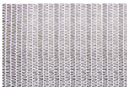
Aus HDPE gefertigtes Gerüstschutznetz. Gewicht: 30 g/m<sup>2</sup>, Schattierwert: bei dunkelgrün 27 %, ca. 15 % bei weiß (nach ASTM1494-92). Reißfestigkeit: Schuss DIN 53857: 109,37 N. Hohe chemische Beständigkeit, auch gegen Lösungsmittel bis zu 60 °C. Entflammbarkeit: ab 340 °C.
