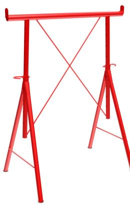
Der meistgekauft in Österreich! Seitliche Laschen am Auflagerohr verhindern ein Abrutschen des Belages. Der Vorstecker im Schrägschlitz gewährleistet unter Belastung beste Standfestigkeit. Mit Fußplatten für einen sicheren Stand auch auf weichem Untergrund. - Auflagebreite 120 cm, - alle 10 cm höhenverstellbar, - max. zulässige Belastung 6 kN bei gleichmäßiger Belastung über die gesamte Breite, - zusammenlegbar.
