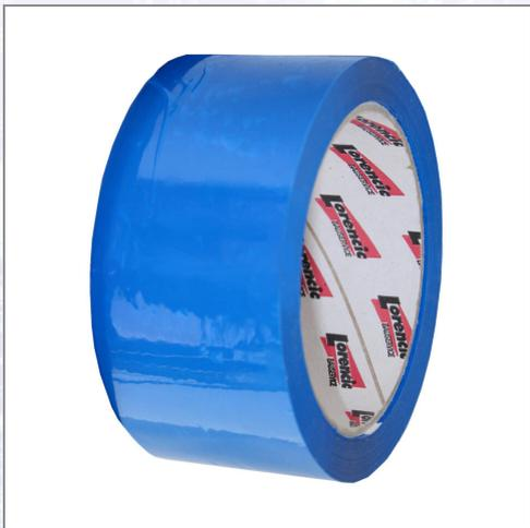
Leicht abrollbares Verpackungsband mit wasserbasiertem Kleber, frei von Lösungsmittel und ohne gesundheitsschädliche Zusatzstoffe. Trägermaterial Polypropylen, Acrylatkleber auf Wasserbasis, Gesamtstärke 48 my, Klebekraft 2,2 N/cm (Stahl), Reißfestigkeit 40 N/cm.
