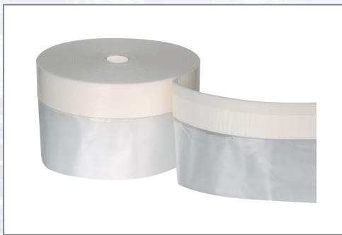
Hochwertiges Schaumband (40 mm x 3 mm, 12 mm Klebekante) zum Einbringen einer Dehnungsfuge an Putzanschlüssen mit angebrachter stabiler HDPE-Folie (550 mm breit) um zusätzliche Abdeckarbeiten einzusparen. Für innen und außen.
