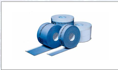
ISO-CONNECT INSIDE FD ist eine extrem flexible und dehnfähige Spezialfolie für die luft- und winddichte Abdichtung von Anschlussfugen bei Fenstern, Türen und Paneelen. Kein Wassereintritt bis 1050 Pa, sd-Wert ca. 39 m. Sie besteht aus einem anpassungsfähigen weichen Kunststoffvlies, welches mit einem Selbstklebestreifen für eine schnelle und rationelle Montage am Fensterrahmen ausgestattet ist. Die dampfdiffusionsgeschlossene Vliesfolie sorgt für eine sichere
