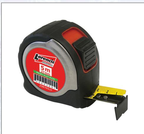
Professioneller Rollmeter aus rostfreiem Stahl mit rutschfester Gummibeschichtung. Bandbreite 27 mm, texturierte Oberfläche des Bandes, Teilung auf beiden Seiten des Bandes (Vorderseite waagerechte Skalierung, Rückseite senkrechte Skalierung), 10 Mal höherer Abriebschutz des Bandes. Sonder-Steifigkeit des Bandes gewährleistet Knickfestigkeit bis 2,6 m horizontal und 4 m vertikal. EG-Genauigkeitsklasse II.
