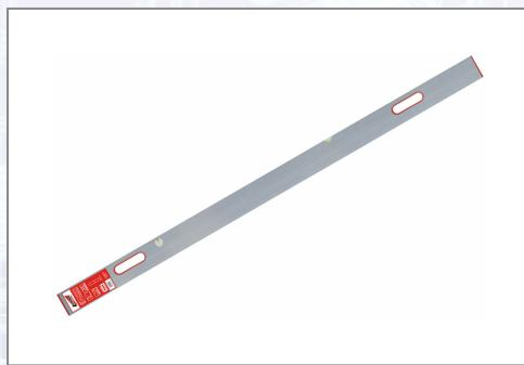
Alu-Rohrprofil mit Mittelsteg, mit 1 Waagrechtlibelle, 1 Senkrechtlibelle und 2 ergonomisch geformte Kunststoff-Handgriffe. Dimensionen ca. 100x18 mm, 860 g/lfm. Entgratetes Profil, daher keinerlei Verletzungsgefahr, bruchfeste Acrylglas-Blocklibellen und stoßgedämpfte Endkappen. Maximale Messtoleranz in Standardposition 0,5 mm/m (0,029 °).
