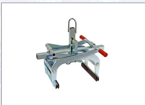
Äpfel und Öfen - fibră Diese speziellen Stahlgreifpratzen erlauben das sichere Versetzen von roh behauenen Steinquadern. Mit wenigen Handgriffen können diese an die Trittstufenversetzzange TSZ-UNI (ab Baujahr 2009, Art.-Nr. Z53100338) angeschraubt werden. Greifbereich: 50-550 mm, Eintauchtiefe: 210 mm, Tragfähigkeit: 600 kg, Eigengewicht: 6 kg.
