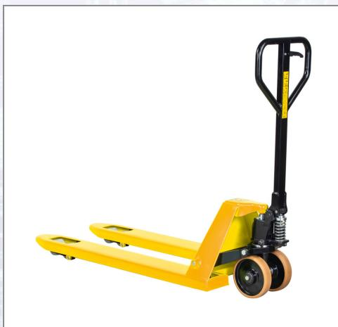
Die hochwertige Pulverbeschichtung gewährleistet sehr guten Schutz gegen Umwelteinflüsse. - Robust, - langlebig, - funktional, - vielseitig, - leichtgängig. Technische Daten: - Lastrollen: Nylon „Tandem“, - Lenkrollen: Gummi, - Tragkraft: 2500 kg bei 600 mm Lastschwerpunkt, - Gabelmaße: 1150x150x55 mm, - Hubbereich min./max.: 85 mm / 200 mm, - Außenmaße: 1550x525 mm, - Staugang: 1835 mm, - Wenderadius: 1367 mm, - Gewicht: 63 kg.
