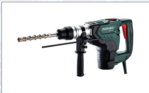
Kombihammer mit 2 Funktionen: Hammerbohren und Mei&szlig;eln. METABO S- automatic Sicherheitskupplung f&uuml;r ein mechanisches Entkoppeln bei Blockieren des Bohrers f&uuml;r sicheres Arbeiten. Robustes Aluminiumdruckguss-Getriebegeh&uuml;use f&uuml;r optimale W&uuml;rmeableitung und Langlebigkeit. Technische Daten: - max. Einzelschlagenergie (EPTA): 7,1 J, - max. Schlagzahl: 2800 /min, - Nennaufnahmleistung: 1100 W, - Bohrdurchmesser: Beton mit Hammerbohrern: 40 mm, Mauerwerk mit
