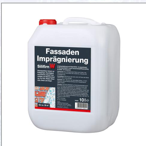
Lösungsmittelfreie Siloxan-Fassadenimprägnierung für mineralische Untergründe. Schützt vor Feuchtigkeit und Schlagregen durch Hydrophobierung. Verhindert Feuchtigkeits- und Wasseraufnahme. Lösungsmittelfrei, auf Wasserbasis, farblos, transparent. Hoch wasserdampfdurchlässig, atmungsaktiv und schmutzabweisend. Verhindert Frost- und Bauschäden, überstreichbar.
