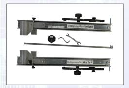
Mit diesem Verlängerungssatz kann die Schnitttiefe des Standgerätes 5305S oder 6005L auf bis zu 43 cm erweitert werden (bei 90°). Zuschnitte bei 45° sind somit bis Dämmplattendicke 30 cm möglich. Mit dem beiliegenden Werkzeug kann der Austausch der Schwenkachsen rasch und einfach vorgenommen werden. Auch ein längerer Turbostab wird mitgeliefert, sodass vor allem bei Zuschnitten von dicken Dämmplatten die Turbofunktion am Standgerät effizient eingesetzt werden kann. Lieferumfang: Obere und untere
