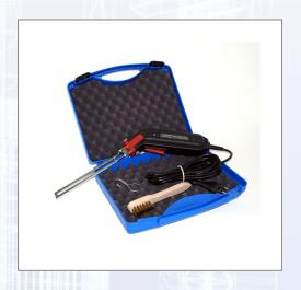
Das leistungsstarke Profigerät für das Bauhandwerk. Für Plattenstärken bis 140, optional bis 160 mm und Profilschnitte. Bereits in 10 Sekunden schneidebereit. Keine Schneidstaubbelastung und keine statische Aufladung. Grundausstattung: STYRO-CUT 140, Schneide C-140 (für Plattenstärke bis 140 mm), Aufhängebügel, Kunststoffkoffer. - Netzspannung 230 V / 50 Hz, - Aufnahmeleistung 110 W, - 3 m Netzleitung, - Schneidetemperatur max. 500 °C, - Gewicht ca. 1 kg.
