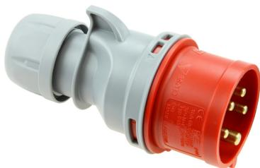
Schnelles und einfaches Einführen der Leitung! Geöffnete Kontaktklemmen im Anlieferzustand. Schraublose Klemme öffnen und schließen mit einem Fingerdruck. Sicherheit: - Aufnahme aller Leiterquerschnitte nach Norm, - Flexible abisierte Drähte (mit oder ohne Aderendhülse oder eindrahtige abisierte Drähte), - Berührungssichere Klemmen, - ÖVE-Zulassung ohne Einschränkung.
