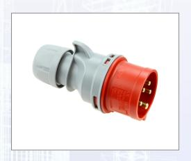
Schnelles und einfaches Einführen der Leitung! Geöffnete Kontaktklemmen im Anlieferzustand. Schraublose Klemme öffnen und schließen mit einem Fingerdruck. Sicherheit: - Aufnahme aller Leiterquerschnitte nach Norm, - Flexible abisolierte Drähte (mit oder ohne Aderendhülse oder eindrahtige abisolierte Drähte), - Berührungssichere Klemmen, - ÖVEZulassung ohne Einschränkung.
