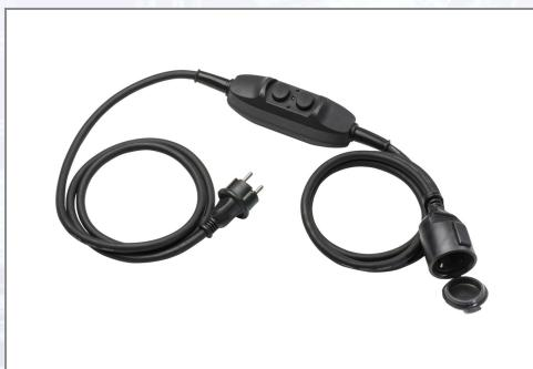
PRCD-Zwischenschalter mit 2x 1,5 Ifm schwerer Gummischlauchleitung H07RN-F 3G1,5 zur Verwendung im Freien. Inkl. Schutzkontaktstecker und Kupplung mit Schutzkappe sowie elektronischer Messeinrichtung, Funktionsanzeige und Testschaltung. Schutzart: IP 44, Bemessungsfehlerstrom: 30 mA, Auslösezeit: 30 mS, 230 V/16 A/max. 3500 W, Gewicht: 0,80 kg.
