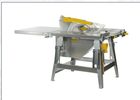
Baukreissäge für die härteren Belastungen am Bau, gemäß EU-Norm ISO 19085-10. Serienmäßige Ausstattung: Sicherheitsschutzhülle und Tischverlängerung, winkelverstellbare Quer- und Keilschneidlehre, unter dem Tisch geschützt angebrachte Führungselemente, abklappbarer Parallelanschlag mit 2 Anlegekanten und millimetergenauer Maßskala, hochwertiges schallgedämpftes Hartmetallsägeblatt, feuerverzinktes und verwindungsfestes Maschinengestell, leistungsstarker Motor mit Magnetbremse, 4 Kranösen,
