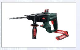
Dieser Kombihammer erfüllt 3 Funktionen: Hammerbohren, Bohren und Meißeln. Die Vario (V)-Elektronik gewährleistet ein Arbeiten mit materialgerechten Drehzahlen. Die METABO Sautomatic Sicherheitskupplung sorgt für ein sicheres Arbeiten durch das mechanische Entkoppeln des Antriebs bei Blockieren des Bohrers. Ausgestattet mit einem LED-Arbeitslicht für optimale Sicht auf die Bohrstelle. Technische Daten: - Akku-Technologie: 18 V Li-Ion, - max. Einzelschlagenergie (EP-TA):
