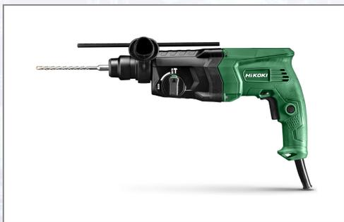
Bohrhammer 730 Watt mit staubgeschützter SDS-Plus-Werkzeugaufnahme und elektropneumatischem Schlagwerk. Bis zu 50 % mehr Luftpolstervolumen verringert den Verschleiß und erhöht die Lebensdauer des Zylinders. Kugellager dichten das Fett ab und halten die Temperatur niedrig, um das Einschmelzen des Getriebedeckels zu verhindern. Druckkontrollmechanismus zur Stabilisierung der Schlagwirkung. Steuerelektronik mit stufenloser Dreh- und Schlagzahlregelung, Sicherheitsrutschkupplung. 2 Funktionen:
