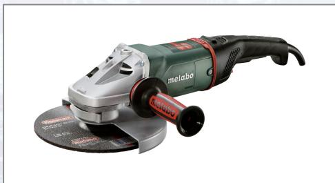
METABO Marathon-Motor mit patentiertem Staubschutz für lange Lebensdauer. METABO Quick für werkzeuglosen Scheibenwechsel durch Schnellspannmutter. Werkzeuglos verstellbare Schutzhülle, verdrehsicher fixierbar. Integriertes Dämpfungssystem METABO VibraTech (MVT) zur Reduzierung der Vibration zum Schutz der Gesundheit. Elektronischer Überlastschutz und Wiederanlaufschutz: verhindert
