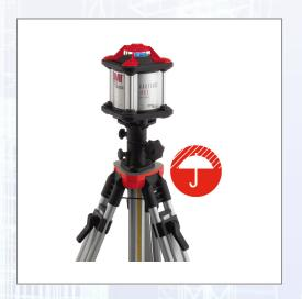
Der Profi für horizontales Nivellieren. Automatischer Laserstopp bei Stoß- und anderen Lageveränderungen. Roter Diodenlaser, Selbstnivellierbereich +/- 6 %, Genauigkeit +/- 2,6 mm - bei 30 m, Reichweite d= 300 m mit Empfänger, Stromversorgung: Netz- oder Akkubetrieb, Betriebsdauer 70 h, wasserdicht nach IP 67, Gewicht 2,5 kg.
