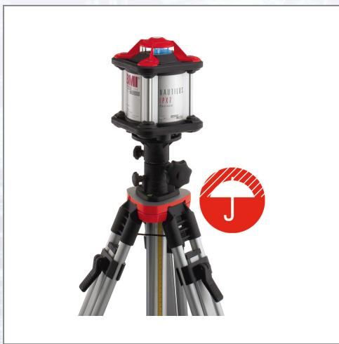
Der Profi für horizontales Nivellieren. Automatischer Laserstopp bei Stoß- und anderen Lageveränderungen. Roter Dioidenlaser, Selbstnivellierbereich +/- 6 %, Genauigkeit +/- 2,6 mm - bei 30 m, Reichweite d= 300 m mit Empfänger, Stromversorgung: Netz- oder Akkubetrieb, Betriebsdauer 70 h, wasserdicht nach IP 67, Gewicht 2,5 kg.
