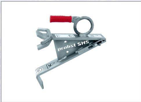
Einfaches und millimetergenaues Versetzen von unhandlichen und schweren Bodenteilen und Schaftkone für Straßenabläufe mit dem kompakten Setzhaken SHS. Passend für Bodenteile mit Ablauf und Schaftkone nach DIN 4052-3. Schaftteile können bereits auf der Palette auf das Bodenteil aufgesetzt werden und lassen sich so in einem Arbeitsgang verlegen. Handlich und passt noch in jede Werkzeugkiste. Galvanisch verzinkt. Tragfähigkeit: 100 kg, Gewicht: 4 kg.
