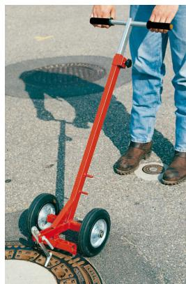
Der Kanaldeckelheber ist robust und für fast alle Arten von Straßenschächten geeignet. Schachtdeckel bis 150 kg (frei sitzende Deckel) können damit gehoben werden. Einfache Bedienung: den Kanaldeckel anfahren, Hebebolzen einführen und den Kanaldeckel anheben. Die Teleskopführungsstange sorgt für eine Vergrößerung der Hebelwirkung und einen geringeren Kraftaufwand. Für weiter innen liegende Kanaldeckel führen wir eine Verlängerung im Programm. Technische Daten:
