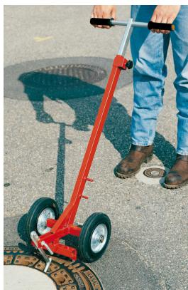
Der Kanaldeckelheber ist robust und für fast alle Arten von Straßenschächten geeignet. Schachtdeckel bis 150 kg (frei sitzende Deckel) können damit gehoben werden. Einfache Bedienung: den Kanaldeckel anfahren, Hebebolzen einführen und den Kanaldeckel anheben. Die Teleskopführungsstange sorgt für eine Vergrößerung der Hebelwirkung und einen geringeren Kraftaufwand. Für weiter innen liegende Kanaldeckel führen wir eine Verlängerung im Programm. Technische Daten:
