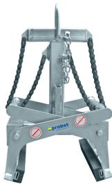
Geeignet zum kraftvollen und sicheren Greifen und Versetzen von Betonfertigteilen, Trittstufen, Bordsteinen und dergleichen. Serienmäßig ausgerüstet: - Greifweitenverstellung über unverlierbare Federrastbolzen. - Einhängeöse für Kranhaken. - Wechselautomatik zur vollautomatischen Umschaltung von voll auf leer. Austauschbare Gummi- Greifelemente. Technische Daten: Greifbereich: 50-520 mm, Eintauchtiefe: 170 mm, Backenlänge: 420 mm, Tragfähigkeit: 900 kg, Gewicht: 55,0 kg.
