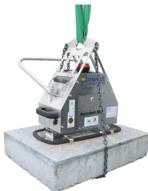
Handlich, robust, netzunabhängig – die konsequente Weiterentwicklung des bewährten Universalgerätes, mit Tragfähigkeit bis 600 kg. Verlegt flexibel, schnell und schonend vorwiegend saugdichte Elemente wie zB Granit. Antrieb über wiederaufladbaren, austauschbaren 12-V-Akku. Leistung durch Stromspar-Automatik ausreichend für einen Arbeitstag. Ladegerät im Lieferumfang nicht enthalten. Einsetzbar an jedem Hebezeug, mit integriertem Kettenfach und Lastsicherungskette. Eigengewicht:
