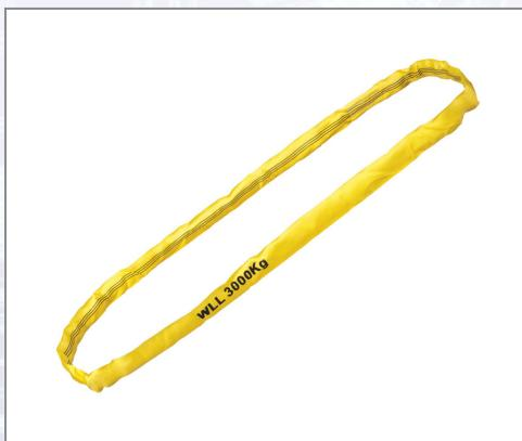
Rundschnüre aus Polyester, Doppelmantel. Hohe Tragfähigkeit bei geringem Eigengewicht. Tragfähigkeit farbcodiert. Sehr flexibles Material, keine Beschädigungen am Hebegut. SF 7:1. Entsprechend EN 1492-2 sowie Maschinen-Richtlinie 2006/42/EG. WLL: direkt: 3000 kg, umgelegt: 6000 kg, geschnürt: 2400 kg, umgelegt  $\beta = 45^\circ$ : 4200 kg, umgelegt  $\beta = 60^\circ$ : 3000 kg.
