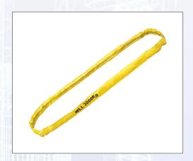
Rundschlinge aus Polyester, Doppelmantel. Hohe Tragfähigkeit bei geringem Eigengewicht. Tragfähigkeit farbcodiert. Sehr flexibles Material, keine Beschädigungen am Hebegut. SF 7:1. Entsprechend EN 1492-2 sowie Maschinen-Richtlinie 2006/42/EG. WLL: direkt: 3000 kg, umgelegt: 6000 kg, geschnürt: 2400 kg, umgelegt  $\beta$ = 45°: 4200 kg, umgelegt  $\beta$ = 60°: 3000 kg.
