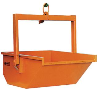
Mit abklappbarem Bügel, Einhängring und Verschlussriegel zur selbständigen Entleerung der Mulde ohne zweiten Mann. Durch klappbaren Aufzugbügel besonders geeignet zu Befüllung mit kleineren Baumaschinen. Stapelbar durch konische Muldenform. Sowohl halb- als auch vollautomatisch lieferbar. Ausführungen von 200 l bis 8000 l Inhalt.
