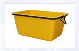
Aus frostbeständigem Spezialkunststoff HDPE. Mit umlaufendem Rohrrahmen und abklappbaren Kranösen. Geeignet zum Krantransport (TÜV Nord GS geprüfte Sicherheit). Auf Wunsch auch in blau (ähnlich RAL 5005), rot (ähnlich RAL 3002), grün (ähnlich RAL 6009), orange (ähnlich RAL 2004) und pink (ähnlich RAL 4010) lieferbar. 1- oder 2-seitiger Kundenaufdruck gegen Aufpreis möglich. Nutzlast: 700 kg.
