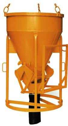
Betonsilo mit zylindrisch-konischer Form und geradem Schlauchanschlussauslauf. Extra schwere stabile Ausführung mit Handhebelbetätigung des Patentverschlusses. Geliefert mit angeschweißter Kette. Auslauf mit d= 200 mm (erhältlich auch mit d= 150 mm oder d= 300 mm). Standard mit 0,6 m PVC-Schlauch d= 200 mm. Lieferbar von 150 l bis 4000 l Inhalt.
