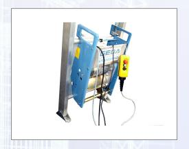
Schrägaufzug Standard mit einer Nutzlast bis 200 kg. - Hubgeschwindigkeit 25 m/min (1-stufig), - Motor 1 kW / 230 V / 50 Hz. Grundeinheit bestehend aus: - Elektrowinde (230 V / 50 Hz) mit 43 m Seil (d= 6 mm), - 21 m Endschalterkabel, - Steuerung (24 V) mit Not-Aus und 5 m Leitung, - Standardschlitten mit Seilbruchsicherung, - Kopfteil mit Schnellverschluss-Umlenkrolle, - 2 m Fußteil.
