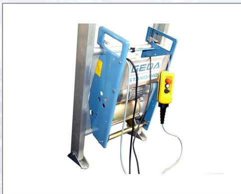
Schrägaufzug Standard mit einer Nutzlast bis 200 kg. - Hubgeschwindigkeit 25 m/min (1-stufig), - Motor 1 kW / 230 V / 50 Hz. Grundeinheit bestehend aus: - Elektrowinde (230 V / 50 Hz) mit 43 m Seil (d= 6 mm), - 21 m Endschalterkabel, - Steuerung (24 V) mit Not-Aus und 5 m Leitung, - Standardschlitten mit Seilbruchsicherung, - Kopfteil mit Schnellverschluss-Umlenkrolle, - 2 m Fußteil.
