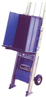
Schrägaufzug Fixlift mit einer Nutzlast bis 250 kg. - 2 Hubgeschwindigkeiten 19 bzw. 38 m/min (2-stufig), - Motor 0,6 / 1,2 kW / 230 V / 50 Hz. Grundeinheit bestehend aus: - Elektrowinde (230 V / 50 Hz) mit 43 m Seil (d= 6 mm), - 21 m Endschalterkabel, - Steuerung (24 V) mit Not-Aus und 5 m Leitung, - Standardschlitten mit Seilbruchsicherung, - Kopfteil mit Schnellverschluss-Umlenkrolle, - 2 m Fußteil, - Steuerung und
