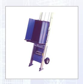
Schrägaufzug Fixlift mit einer Nutzlast bis 250 kg. - 2 Hubgeschwindigkeiten 19 bzw. 38 m/min (2-stufig), - Motor 0,6 / 1,2 kW / 230 V / 50 Hz. Grundeinheit bestehend aus: - Elektrowinde (230 V / 50 Hz) mit 43 m Seil (d= 6 mm), - 21 m Endschalterkabel, - Steuerung (24 V) mit Not-Aus und 5 m Leitung, - Standardschlitten mit Seilbruchsicherung, - Kopfteil mit Schnellverschluss-Umlenkrolle, - 2 m Fußteil, - Steuerung und Endschalter steckbar.
