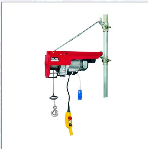
Schwenkarmaufzug mit einer Tragekraft bis zu 200 kg, Motortyp: Einphase, Spannung: 220 V, Frequenz: 50-60 Hz, Leistungsaufnahme: 1350 W, Seillänge: 40 m, Hubgeschwindigkeit: 39 m/min, Seildurchmesser: 4 mm, Eigengewicht: 39 kg. Im Lieferumfang enthalten: Fernbedienung, 2 Stück Gerüstklemmen, obere Zugstange.
