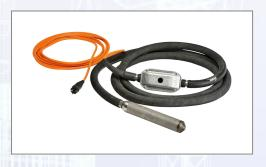
Der LATI U ist eine Kombination aus Innenrüttler und Frequenzumformer. Der Umrichter ist im Schaltergehäuse integriert und somit ist der direkte Anschluss an 230 V / 50 Hz möglich. Große Betriebssicherheit, außerordentliche Verdichtungsleistung und robuste Konstruktion zeichnen ihn aus. LATI U arbeiten mit 12.000 U/min. Ausgestattet mit Hochfrequenz-Vibriernadel mit 5 m Schutzschlauch, Schalter mit integriertem elektronischen FU, 10 m Kabel und Schukostecker.
