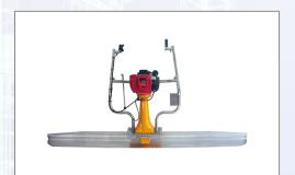
Rüttelbohle mit doppeltem Griff, Benzinmotor HONDA GX35 4-Takt 1,5 PS. Extra leichte, einfache Handhabung, geeignet für Betonböden. Zur Verwendung mit Winkelprofil-Abziehpatschen von 2 bis 5 Metern. Gewicht: 15 kg.
