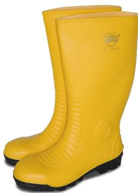
Für den Einsatz beim Arbeiten mit handgeführten HD-Reinigern. Druckfest bis 800 bar, bei Rückstoßkraft der Lanze bis 117 N, bei Düsengröße bis 1,0 mm, mit Abstand bis 75 mm Düse zu Stiefel, bei Vorschubgeschw. bis 0,2 m/sek. und Wasserfluss bis 17,7 l/min. Gem. Prüfgrundlage EN 345-1-Juni 1997, BGR 191, Absatz 3.1.5.5.3, Schutzstufe S5, Größen: 43 - 45.
