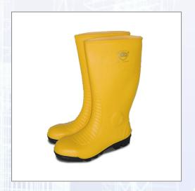
Für den Einsatz beim Arbeiten mit handgeführten HD-Reinigern. Druckfest bis 800 bar, bei Rückstoßkraft der Lanze bis 117 N, bei Düsengröße bis 1,0 mm, mit Abstand bis 75 mm Düse zu Stiefel, bei Vorschubgeschw. bis 0,2 m/sek. und Wasserfluss bis 17,7 l/min. Gem. Prüfgrundlage EN 345-1-Juni 1997, BGR 191, Absatz 3.1.5.5.3, Schutzstufe S5, Größen: 43 - 45.
