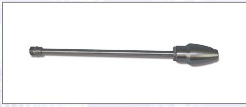
Set bestehend aus: - Düsenrohr 600 bar, 300 mm, G 1/4 ", - Rot.Düse F 030 500, - Rohrgewindedichtung hochfest rot 50 g Tube. Vormontiert und direkt einsatzbereit. Technische Daten: - Druckklasse: 500 bar, - Druck max.: 500 bar, - max. Temperatur: 150 °C, - Verbindungstyp (Eingang): M24 x 1,5 AG.
