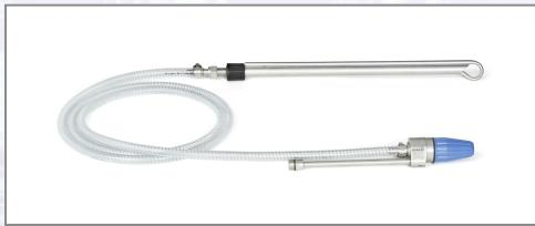
Ringförmige Anordnung der Hochdruckdüsen mit zentraler Strahlmittelzuführung im Sandstrahlkopf für optimale Ergebnisse. Geeignet für Strahlmittel mit einer Korngröße von 0,2 - 1,4 mm bei bis zu 95 °C. Set bestehend aus: - Strahlkopf inkl. Düzensatz Form O, - Saugschlauch, - Saugrohr, - Strahlrohr mit Kupplung M22 x 1,5 AG.
