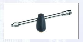
Set bestehend aus: - Gegennippel M22 x 1,5 AG - 1/4 " IG 500 bar, - Düsenrohr 500 bar, 350 mm, G 1/4 ", - Rot.Düse F 050 350, - Rohrgewindedichtung hochfest rot 50 g-Tube, - Verschlusskappe M22 x 1,5 IG. Vormontiert und direkt einsatzbereit. Technische Daten: - Druckklasse: 350 bar, - Druck max.: 350 bar, - max. Temperatur: 150 °C.
