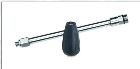
Set bestehend aus: - Gegennippel M22 x 1,5 AG - 1/4 " IG 500 bar, - Düsenrohr 500 bar, 350 mm, G 1/4 ", - Rot.Düse F 050 350, - Rohrgewindedichtung hochfest rot 50 g-Tube, - Verschlusskappe M22 x 1,5 IG. Vormontiert und direkt einsatzbereit. Technische Daten: - Druckklasse: 350 bar, - Druck max.: 350 bar, - max. Temperatur: 150 °C.
