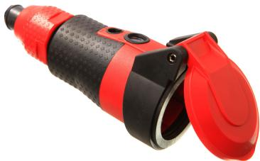
Extrem robuste, belastbare Schuko-Kupplung mit Spannungsanzeige, selbstschließendem Klappdeckel, Knickschutztüle und Schnellverschluss. Spritzwassergeschützt IP 54, 16 A, 230 V, nach DIN 49440/441, zum Anschluss von Leitungen bis 3x2,5 mm<sup>2</sup>. Schlagfest, griffig und rutschfest aufgrund Zwei-Komponenten-Technologie. UV- und medienbeständig, hitzebeständig bis 80 °C, kältebeständig bis -40 °C. Zuverlässige Verbindung von Stecker und Kupplung durch Deckel-Verrastung.
