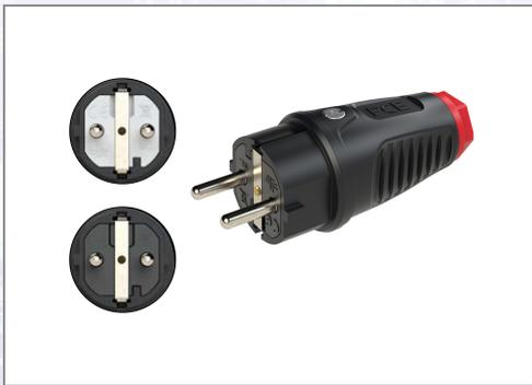
Steckermodule mit Schnapp-In Zugentlastung und Membrandichtung. Einfaches Montieren und Demontieren der Kontaktträger, großer Anschlussraum, leicht bedienbare Zugentlastungselemente (offene Schrauben). Im Steckerteil offene +/- Kontaktschrauben, ausgerichtet, Trichtereinführung der Leiter, offene Zugentlastung. Für erschwerte Bedingungen geeignet, 16 A 250 V, 3p (2P+E). Farbe: (Haube/Ring): schwarz/rot. IP 54 staub- und spritzwassergeschützt, nach österreichischer/deutscher Norm.
