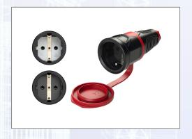
Leicht bedienbare Zugentlastungselemente (offene Schrauben), großer Anschlussraum, einfache Erstmontage. Kontakt-Anschlusssystem: alle Schrauben sind aus einer Richtung bedienbar (parallel ausgerichtet). Im Kupplungsmodul offene +/- Kontaktschrauben, ausgerichtet, Trichtereinführung der Leiter, offene Zugentlastung. Für erschwerte Bedingungen geeignet, 16 A 250 V, 3p (2P+E). Farbe: (Haube/Ring/Deckel): schwarz/rot/rot . IP 54 staub- und spritzwassergeschützt, nach österreichischer/deutscher
