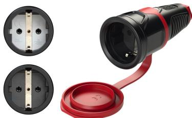
Leicht bedienbare Zugentlastungselemente (offene Schrauben), großer Anschlussraum, einfache Erstmontage. Kontakt-Anschlussystem: alle Schrauben sind aus einer Richtung bedienbar (parallel ausgerichtet). Im Kupplungsmodul offene +/- Kontaktschrauben, ausgerichtet, Trichtereinführung der Leiter, offene Zugentlastung. Für erschwere Bedingungen geeignet, 16 A 250 V, 3p (2P+E). Farbe: (Haube/Ring/Deckel): schwarz/rot/rot . IP 54 staub- und spritzwassergeschützt, nach österreichischer/deutscher Norm.
