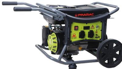
Alle Stromerzeuger der WX-Baureihe sind mit AVR (Automatic Voltage Regulation) ausgestattet. Durch die elektronische Regelung der Stromstärke werden angeschlossene Geräte besser gegen Beschädigungen durch Überspannungen geschützt. Die eingebaute Ölängelsicherung schaltet den Motor bei zu geringem Ölstand ab. Weiters sind alle WX-Geräte mit einem Multifunktionsdisplay ausgestattet, es können Spannung, Frequenz und Betriebsstunden abgelesen werden.
